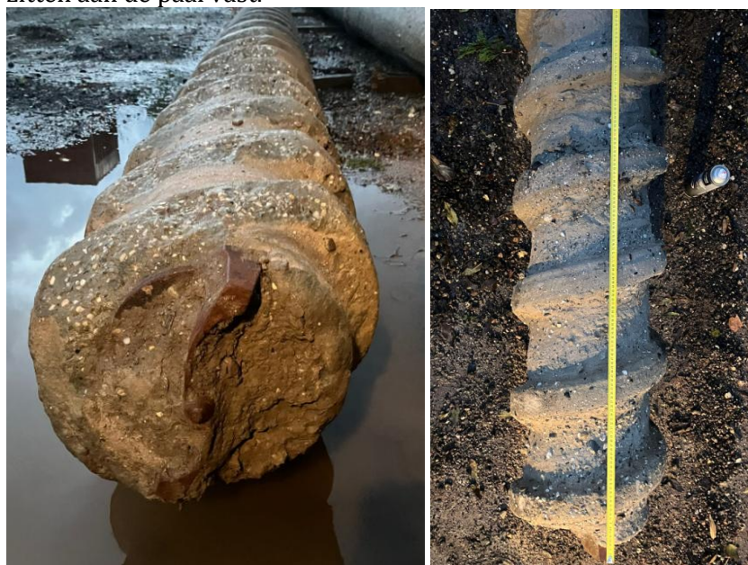
FIGUUR 17 GETROKKEN DPA PLUS PALEN WERKENDAM
