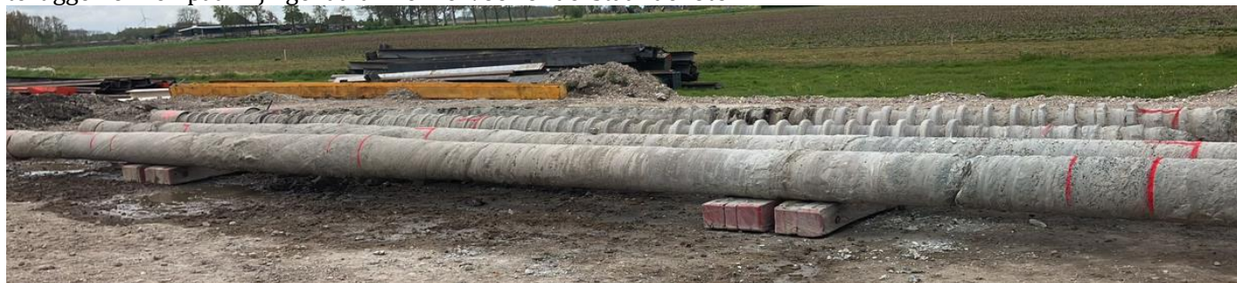
FIGUUR 26 GETROKKEN PALEN OOSTWOUD, PAALKOP AAN DE LINKER ZIJDE
