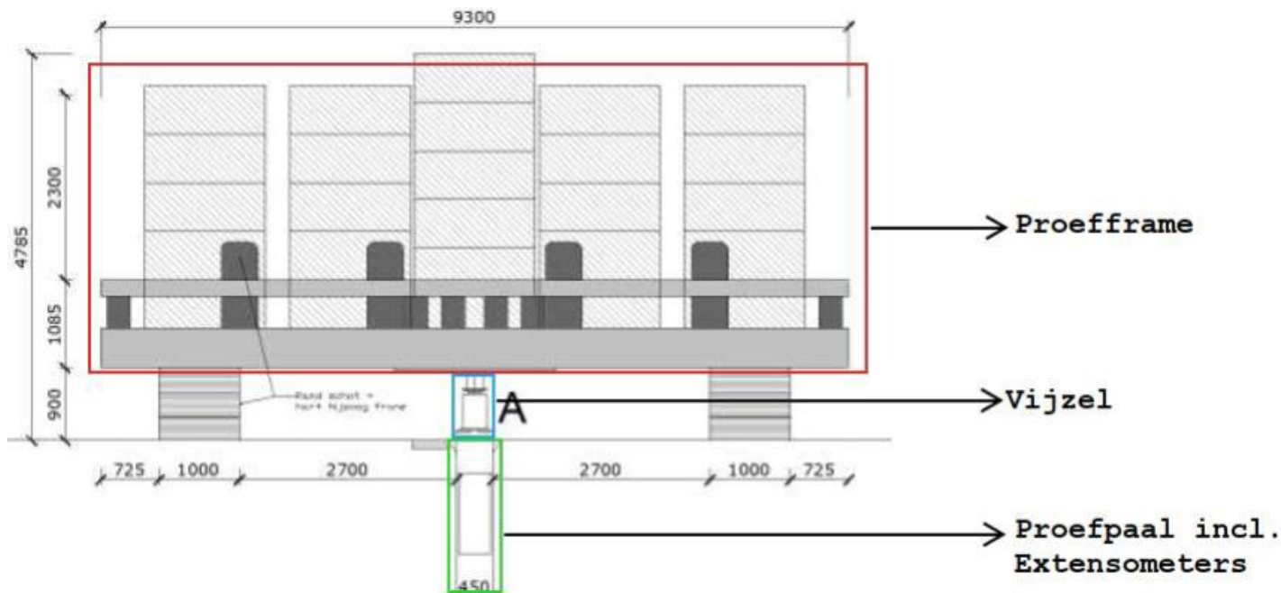
FIGUUR 11 TEKENING VAN DE PROEFPAAL MET VIJZEL OP REACTIEFRAME MET BALLAST
