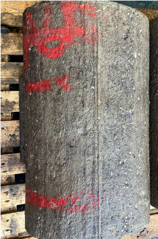
Zichtbaar breedte scheuren in de moten beton.
